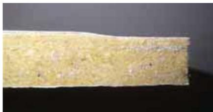
Les panneaux Mono Acoustic TE sont en laine de roche haute densité. Revêtus sur leur face apparente d'un voile de verre blanc, ils sont contrefacés par une membrane haute performance et durable. Les panneaux Mono Acoustic TE disposent sur leurs quatre côtés d'un bord aminci permettant le traitement des joints.
